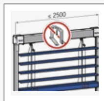
Construction de stores autoporteuse
